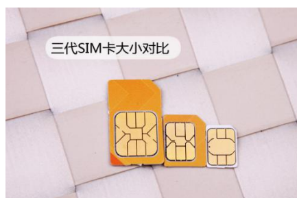
图 2.4-1 三代 SIM 卡尺寸
